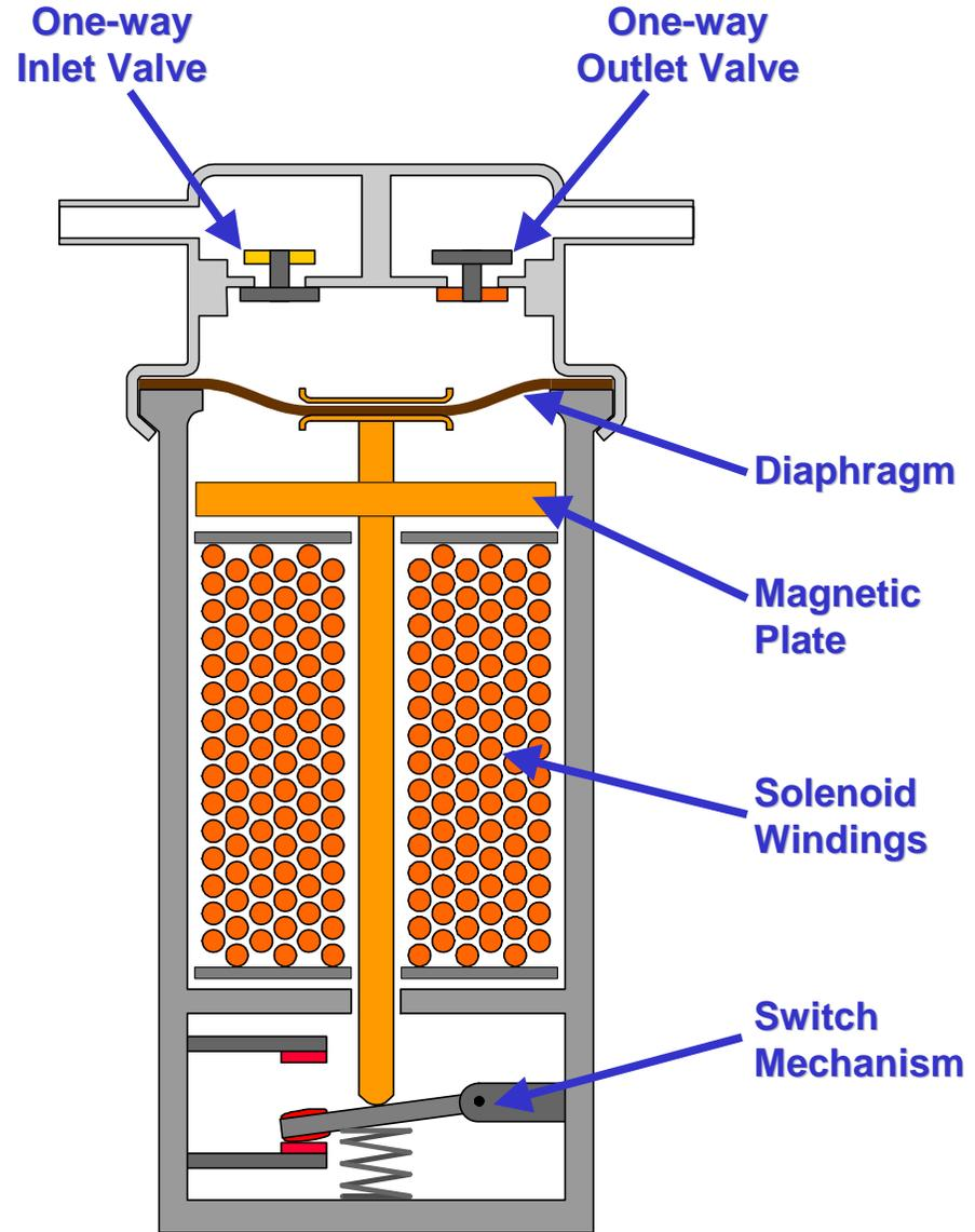
**FUEL PUMP – Solenoid Diaphragm Pump**
